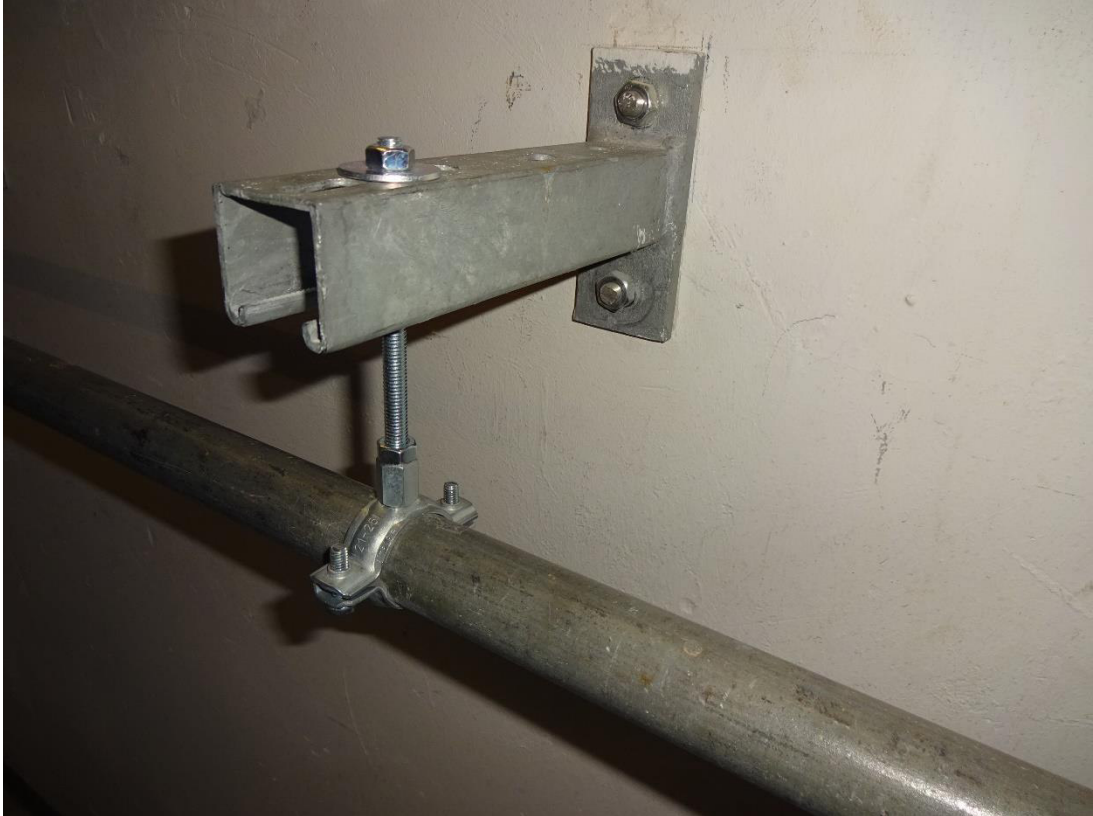
Bild 1: Bezugsmessung: DÄMMGULAST®, „Typ 1“, starrer Anschluss ohne Dämmelement
