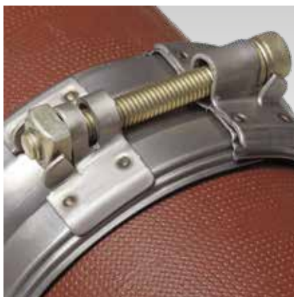
Voor het vastdraaien van de buisverbinder: controlesleuf open
