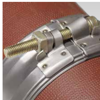
Optische controle: Na het vastdraaien van de buisverbinder: controlesleuf gesloten
