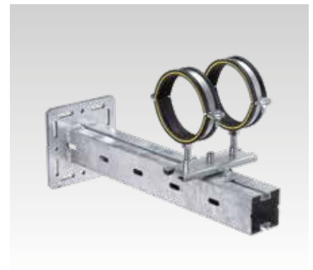
Montage von zwei Schraubrohrschellen mit Anschlussgewinde M16 auf einer MPT-Konsole, Q100
