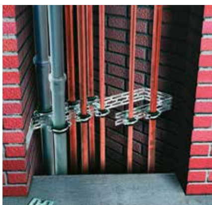
Montage im Schacht: Durchsteckmontage mit zwei Rohrschellen und einem Gewindestift M8 oder M10 für die Befestigung paralleler Rohrleitungen
