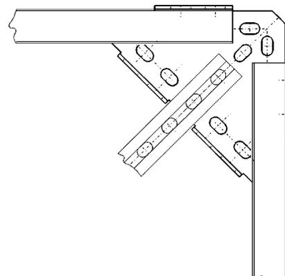
En assemblage de rail, l'ouverture du rail peut être positionnée selon le besoin
